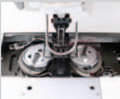
Die PFAFF 1122-G ist eine Maschine mit großen Greifern = großes Spulenfadenvolumen.
