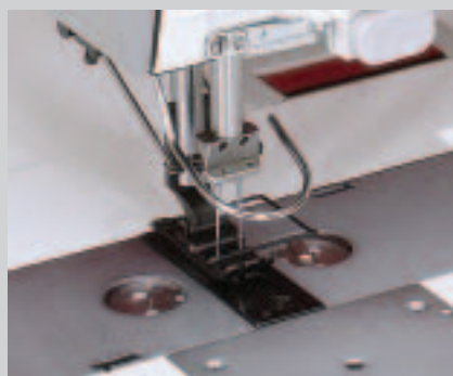
Sichtfenster für die optische Erkennung des Spulenfadenvolumens Sight glass for viewing the bobbin thread volume
